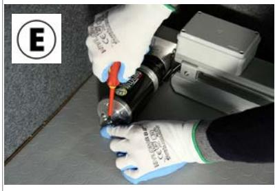
● Bloccare il MOTORE con vite autofilettante. In alcune tipologie di pavimenti potrebbe essere necessario bloccare con vite e dado.
