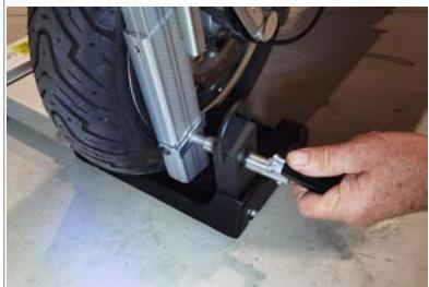
● Bloccare la ruota avvitando il morsetto inferiore
