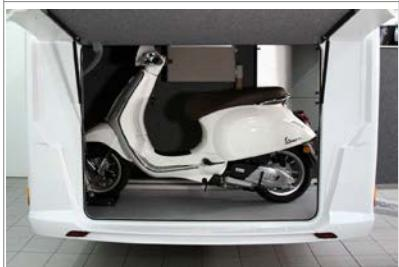
🇮🇹 A carico completato, controllare che la ruota anteriore non tocchi la parete del camper
