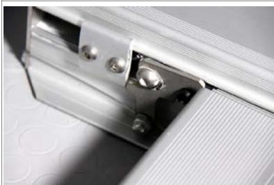
● Pinza correttamente bloccata sul finecorsa
