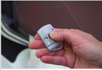
● Premere il pulsante di salita e tenerlo premuto fino a completare il carico dello scooter
