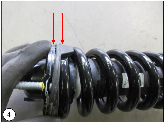
**NL** Let op: het kan zijn dat het windingsaantal van de MAD veer niet gelijk is aan dat van de originele veer. Verdraai in dat geval de metalen bovenschotel ten opzichte van de rubberen veerschotel. Zorg ervoor dat de bovenschotel uitgelijnd is met het oog van de demper.
